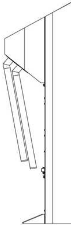
Рисунок 17 – Турникет со сложенными планками (центральная стойка турникета)
